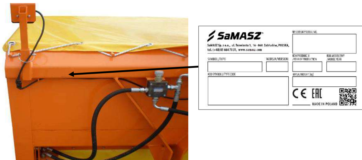
Рис. 1. Заводской щиток и его расположение
