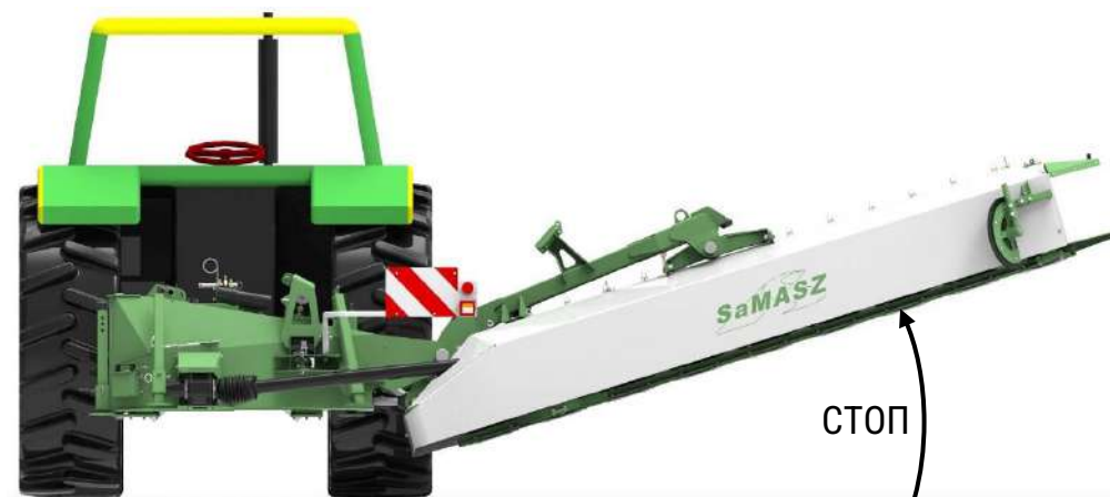
Рис. 17. Расположение косилки в позиции проезда на поворотах
