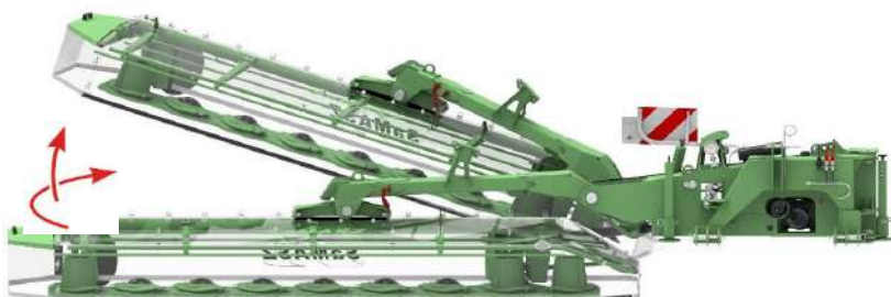
Рис. 10. Отклонение косилки назад после задействования предохранителя
