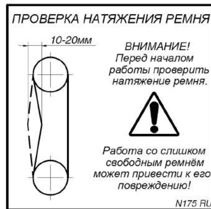
Рис. 35. Контроль и натяжение зубчатого ремня
