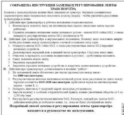
N-80 - Замена и регулирование ленты Транспортёра
