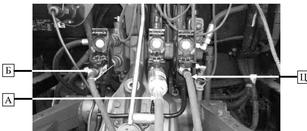
Рис. 14б. Подключение гидравлических проводов к трактору из косилки со вспушивателем/вальцами
