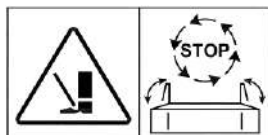
N-48 Не прикасаться к элементам машины до полного остановления всех её элементов
