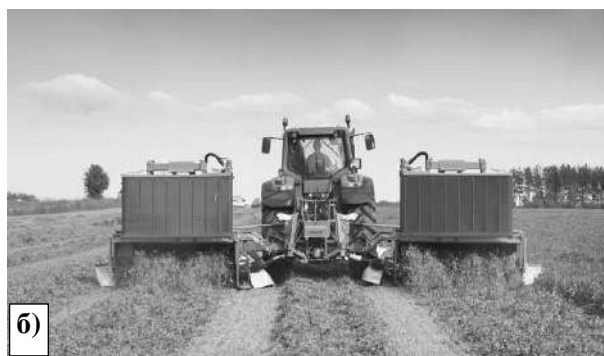
Рис. 22. Работа с использованием транспортеров покоса и без них
