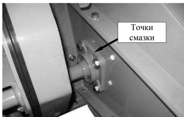
Рис. 52. Точки смазки подшипника самоустанавливающегося смазкой LT43
