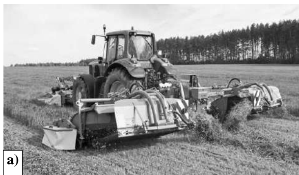
Рис. 22. Работа с использованием транспортеров покоса и без них
