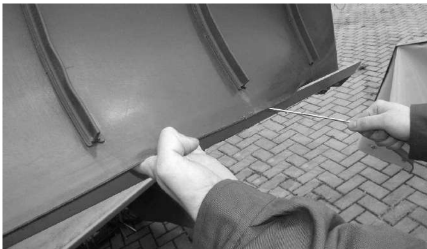
Рис. 41. Устранение загрязнений внутри ленты
