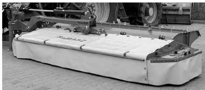
Рис. 8. Крепление брезентовой защиты на косилке
