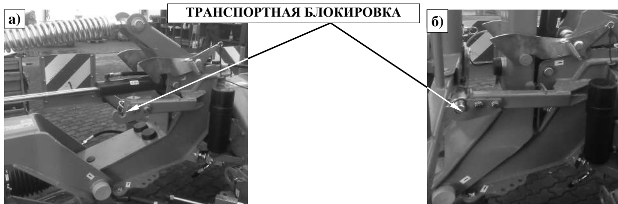
Рис. 19. Транспортная блокировка: а) рабочее положение (кошене), б) Транспортное положение с поднятой косилкой
