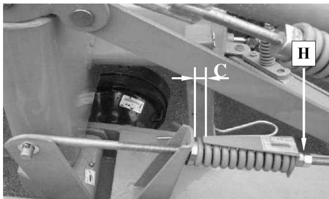
Рис. 29. Проверка натяжения клиновых ремней
