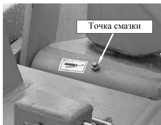
Рис. 36. Точка смазки вертикальной оси навесного устройства
